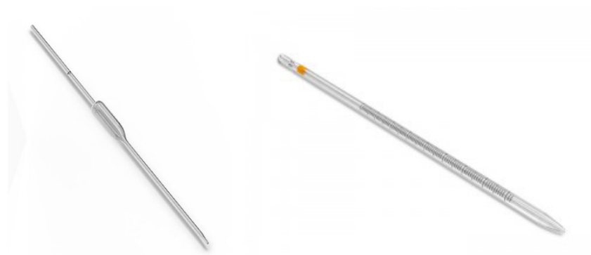
Рис. 2. Внешний вид мерной пипетки с одной меткой—пипетки Мора (слева) и градуированной мерной пипетки (справа).
