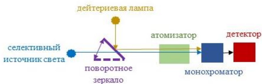
Рисунок 1.12.5. Спектральная схема дейтериевой коррекции
