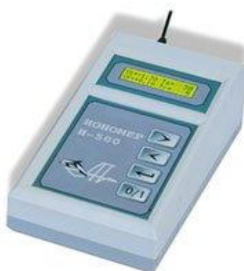
Рисунок 3.3.1. Общий вид иономера И-500.Клавиши: «>» и «<» позволяют перемещаться меню и устанавливать числовые значения; «←» подтверждать введенные значения или вызывать выбранные параметры; «O/I» включать и выключать прибор
