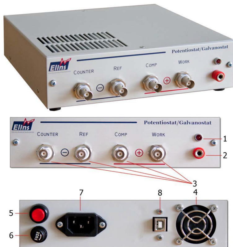
Рисунок 3.10.1 Потенциостат-гальваностат серии Р-30: общий вид прибора, передняя панель, задняя панель. Обозначения: 1 — индикатор питания, 2 — разъем заземления и экранирования, 3 — разъемы подключения измерительных электродов, 4 — вентилятор охлаждения, 5 — кнопка включения питания, 6 — гнездо предохранителя, 7 — разъем питания (220 В), 8 — USB разъем для подключения прибора к ПК
