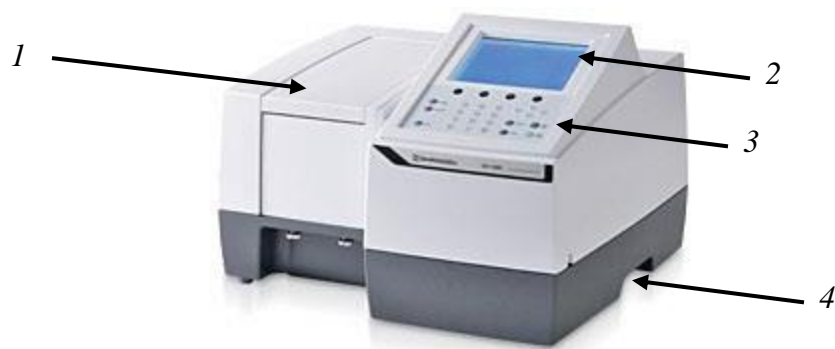
Рисунок 2.2.2. Внешний вид спектрофотометра Shimadzu UV/Vis 1280: 1 – кюветное отделение, 2 – цифровой дисплей, 3 – приборная панель, 4 – кнопка включения
