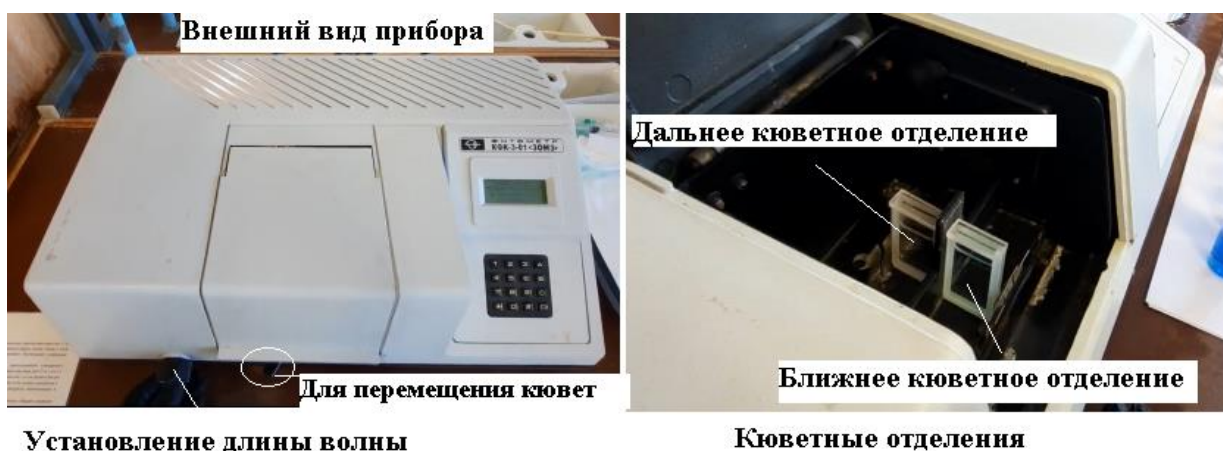
Рисунок 2.2.4. Составные элементы фотоэлектроколориметра КФК-3-01
