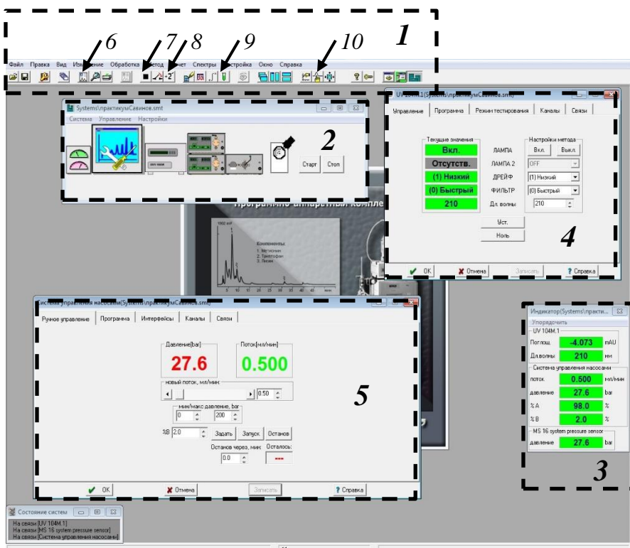
Рисунок 4.4.1. Внешний вид рабочего окна программы «МультиХром»: 1 – панель инструментов, 2 – окно общих настроек хроматографа, 3 – окно состояния хроматографа, 4 – окно управления детектором, 5 – окно управления насосами, 6 – кнопка создания простого отчета, 7 – кнопка остановки регистрации хроматограммы, 8 – кнопка увеличения продолжительности регистрации хроматограммы на 2 мин, 9 – кнопка перехода к количественному анализу, 10 – кнопка перехода к ручному режиму ручного расчета аналитического сигнала
