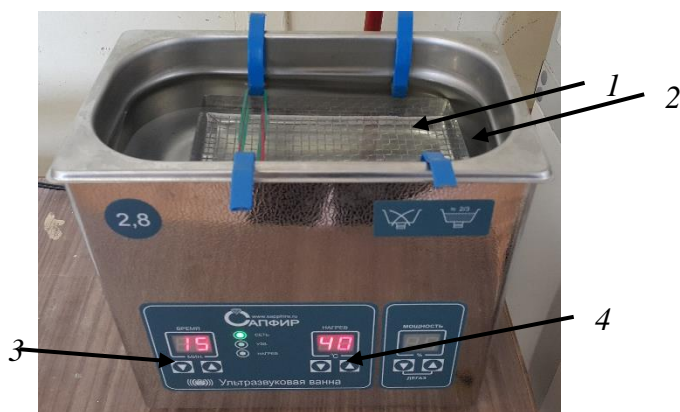
Рисунок 4.4.1. Внешний вид УЗ-ванны: 1 – решетка для установки емкостей с пробами, 2 – емкость УЗ-ванны, 3 – кнопки настройки продолжительности УЗ-воздействия, 4 – кнопки настройки температуры раствора в емкости ванны
